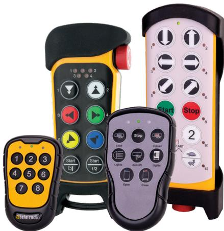
**CAT3** **PLd** Aquellas botoneras con seta de paro están aprobadas de acuerdo con la norma ISO 13849-1 CAT3, PLd. Funciona con dos relés de parada con dos microprocesadores de seguridad independientes que se chequean entre sí. Si uno de los dos relés abre, la máquina se detendrá por seguridad.
